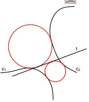
Mit diesem Menüpunkt lassen sich alle Kreise ermitteln, die eine Gerade t und die Kurven Kurve1 ( $c_1$ ) und Kurve2 ( $c_2$ ) berühren. Der Gerade t und die Kurven müssen natürlich in einer Ebene liegen. Die Kurven  $c_1$  und  $c_2$  können auch Kreise sein.
