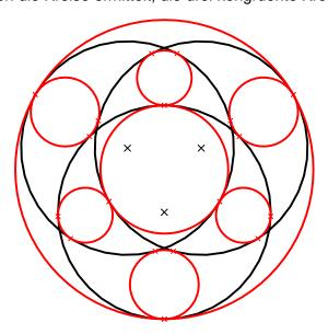
Die Anzahl der Ergebniskreise in den neuen Menüpunkten ist unterschiedlich. Es werden alle Lösungskreise dargestellt, außer jene, deren Durchmesser größer sind als das 10 – fache der Länge der Raumdiagonale des gesamten Projektes.
