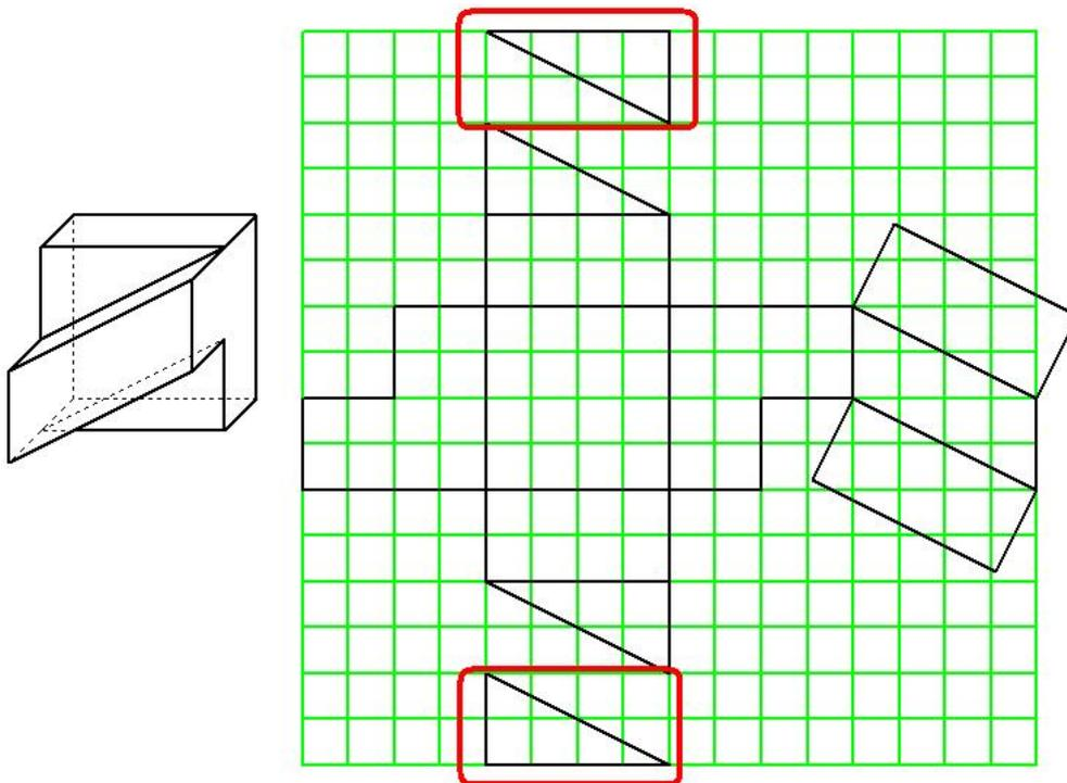
Die beiden rot eingekreisten Teile sind zu viel, da das Programm die beiden Dreiecke in der gleichen Ebene sieht. Zeichne trotzdem das Netz zunächst fertig. Lösche dann das Raster und entferne die überflüssigen Linien mit Modellieren/ Kanten entfernen/ einzeln.
